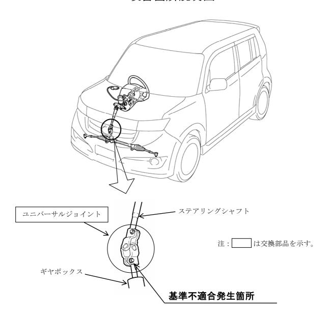
ステアリングシャフトとギヤボックスを連結しているユニバーサルジョイントの締結ボルトに締め付けが不足しているものがある。そのため、据え切り操作を行うと連結部に緩みが生じ、そのままの状態で使用を続けると異音が発生し、最悪の場合、連結部が外れてかじ取り操作ができなくなるおそれがある。
