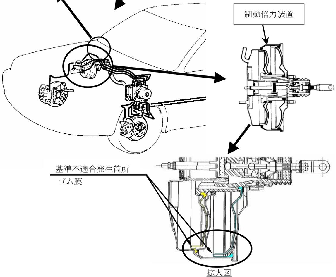
制動倍力装置において、高温が長く使用条件を想定していなかったため、当該使用条件下で継続的に使用された場合、制動倍力装置内のゴム膜が熱により劣化するものがある。そのため、そのまま使用を続けると、当該ゴム膜に亀裂が発生し、倍力作用が損なわれて制動停止距離が伸びるおそれがある。
