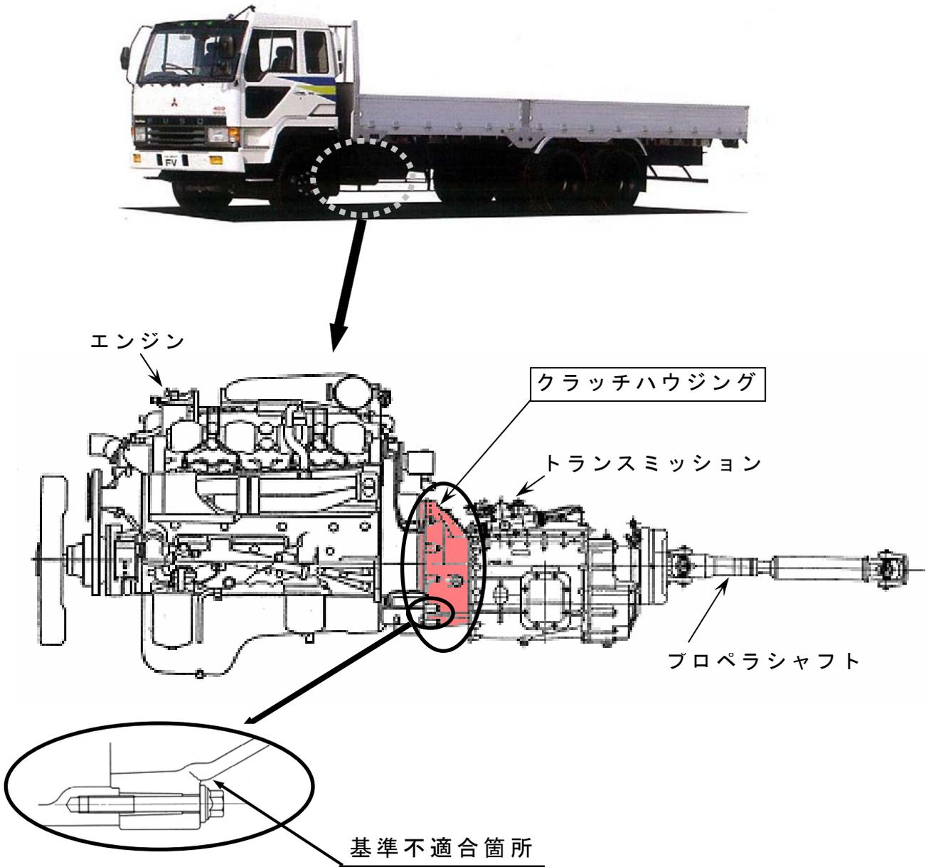
エンジンとトランスミッションの結合部（クラッチハウジング）の強度が不足しているため、高速走行時に駆動系の振動が増加した場合、クラッチハウジングに亀裂が生じるものがある。そのため、そのままの状態で使用を続けると亀裂が進行し、最悪の場合、クラッチハウジングが破断するおそれがある。
