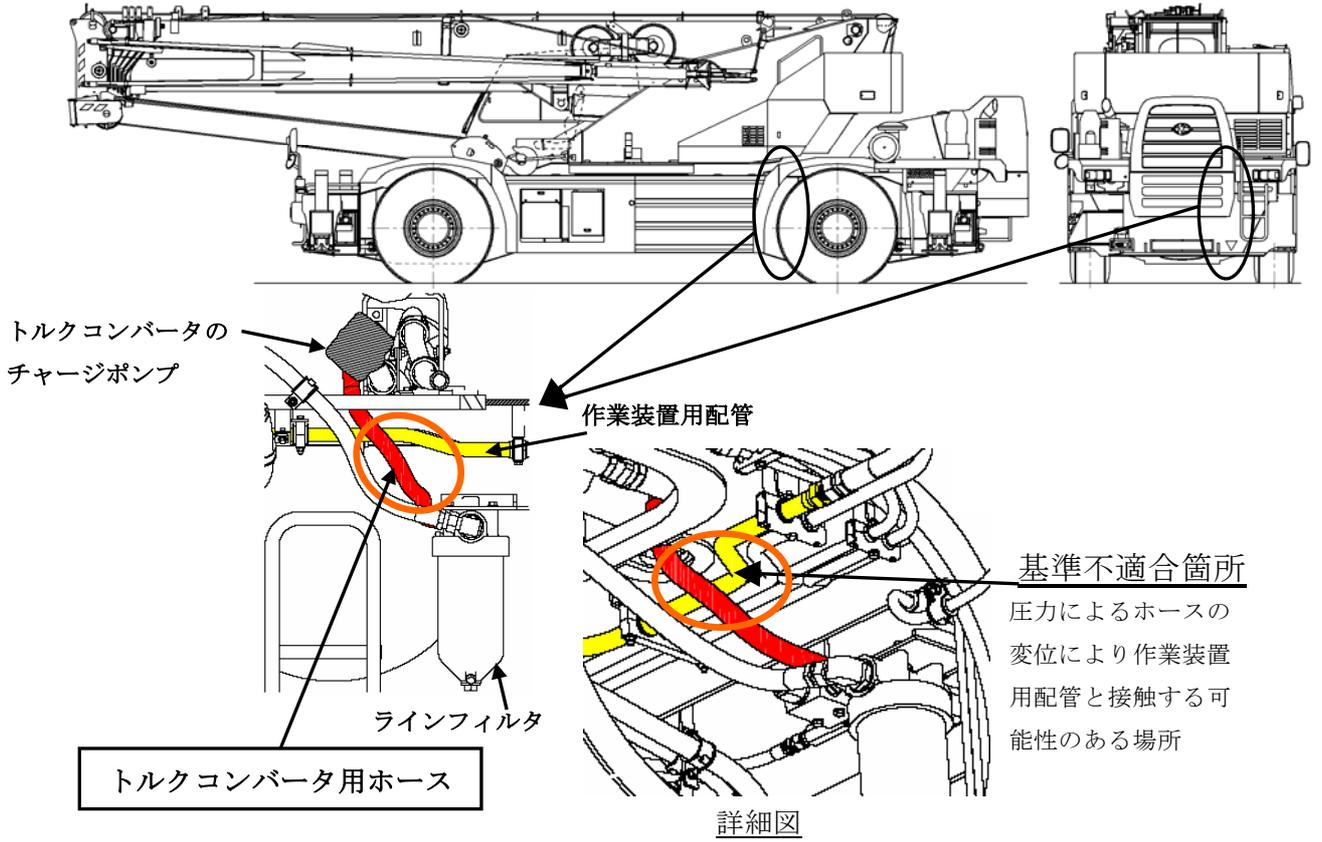
トルクコンバータ用ホースが固定されていないため、作業装置用配管と接触する場合があります。
