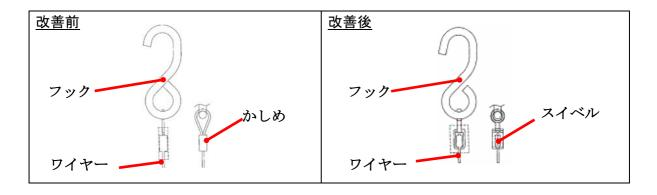
識別:フックとワイヤー締結部のスイベル機構の有無で識別する。
