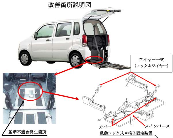
スロープ式車いす移動車において、車いす固定用ワイヤーがねじれやすいため、ワイヤーを滑車に保持するためのカバーが動き、ワイヤーが滑車から外れる場合がある。そのため、ワイヤーがカバーと干渉し、最悪の場合、ワイヤーが切れて車いすを固定できなくなるおそれがある。
