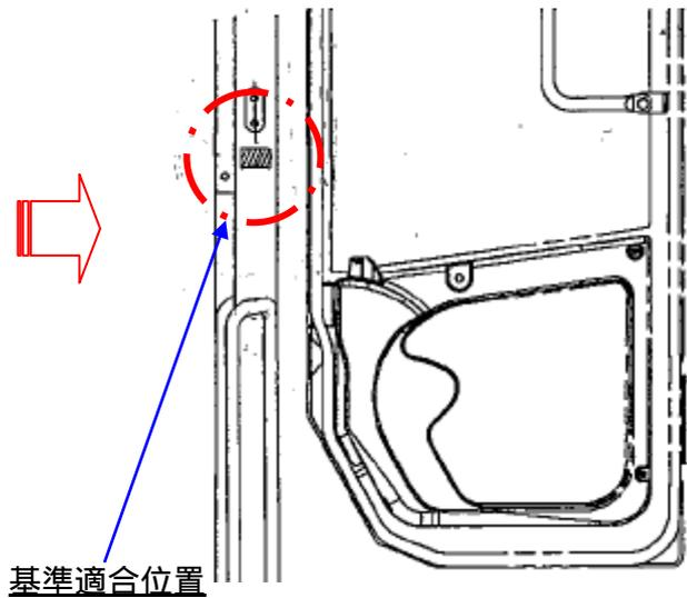
前面ガラス又は側面ガラスに銘板(注意銘板等)を貼付したため道路運送車両の保安基準に適合していない。
