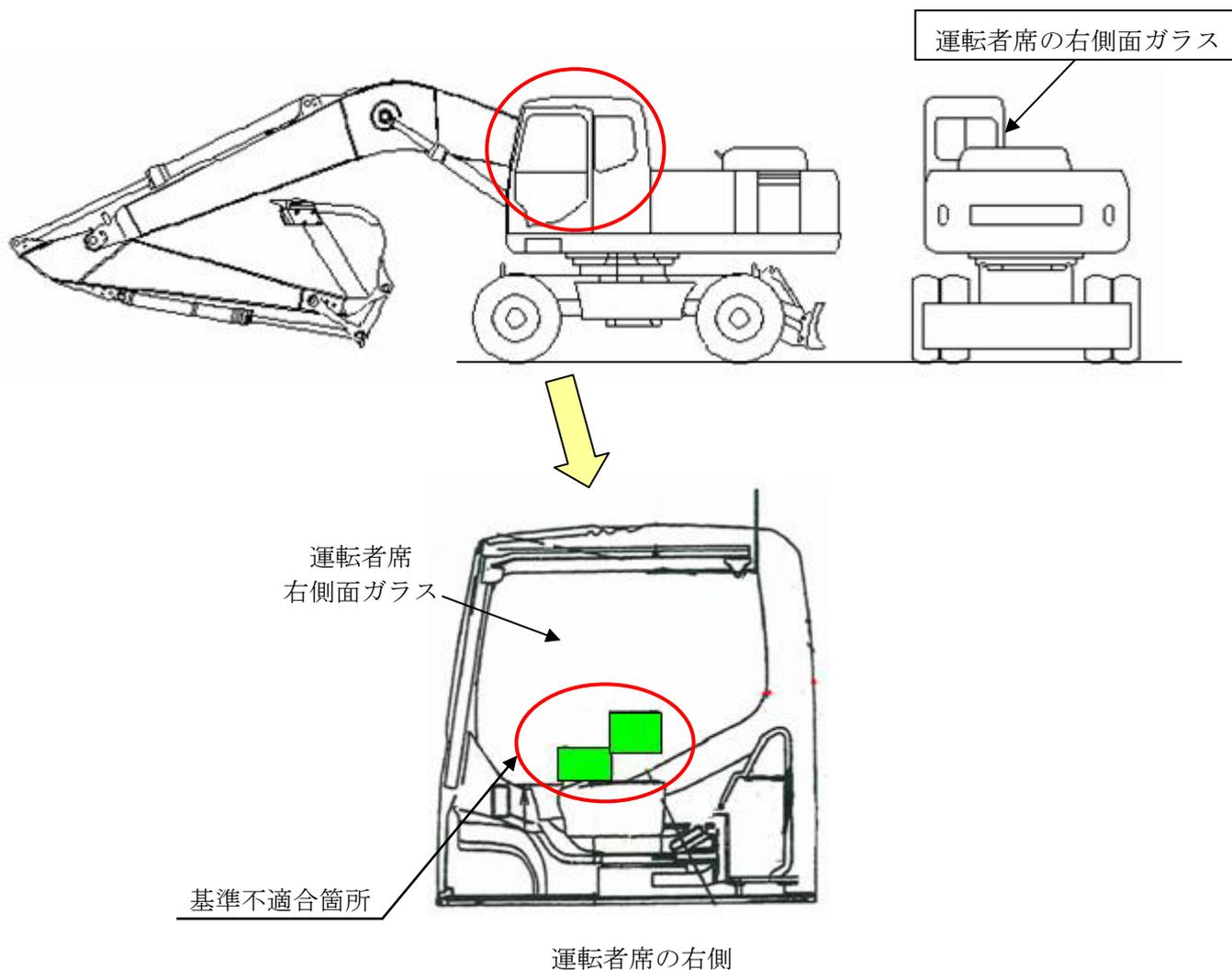
〔 前面ガラス又は側面ガラスに銘板(注意銘板等)を貼付したため道路運送車両の保安基準に適合していない。 〕
