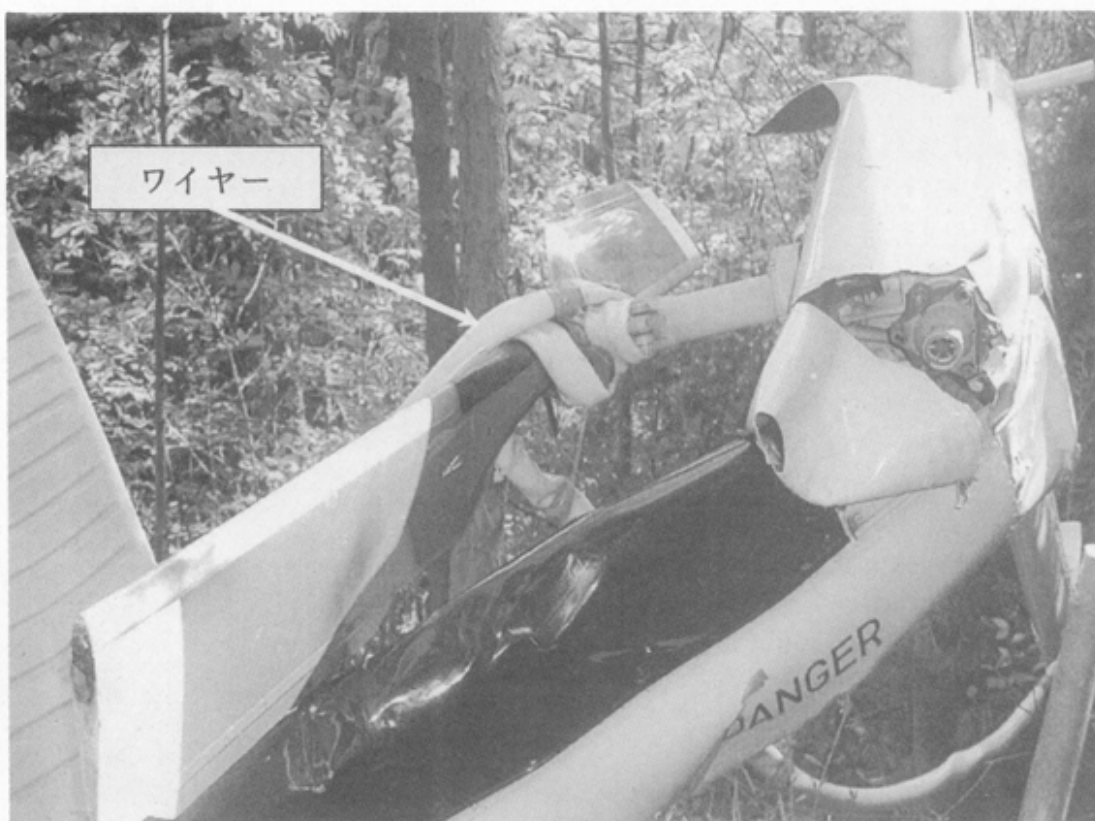
写真2 テール部損傷状況
