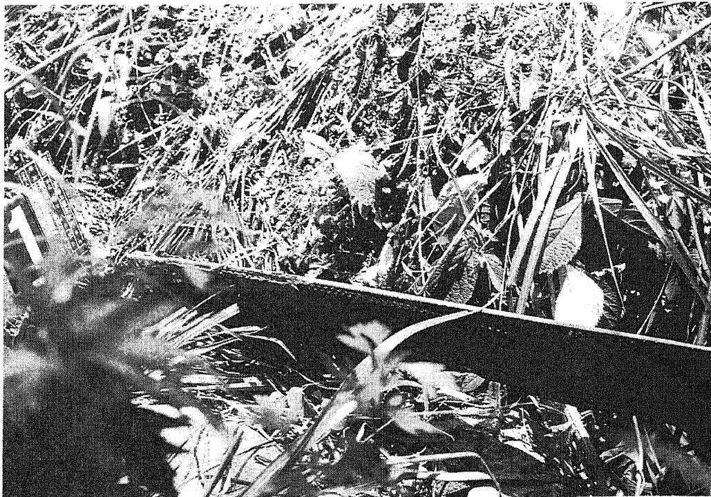
写真2 メイン・ロータ・ブレードのワイヤ接触痕跡
