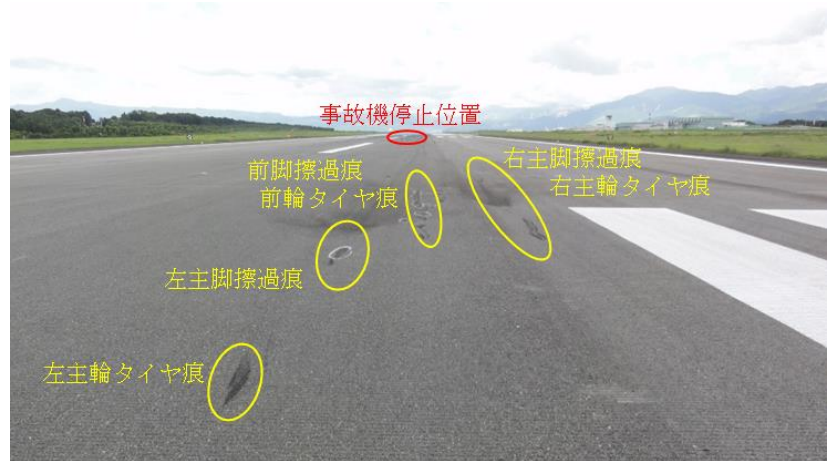
写真3 接地痕の状況
