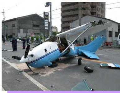
燃料/空気比が過剰に濃厚となり、燃料の着火が阻害されて、エンジンが停止
