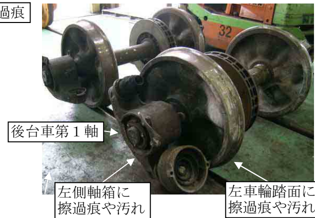
1 両目後台車輪軸の損傷状況
