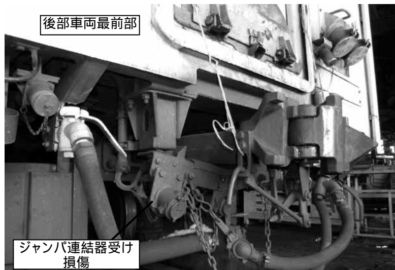
写真6 車両の損傷状況(2)
