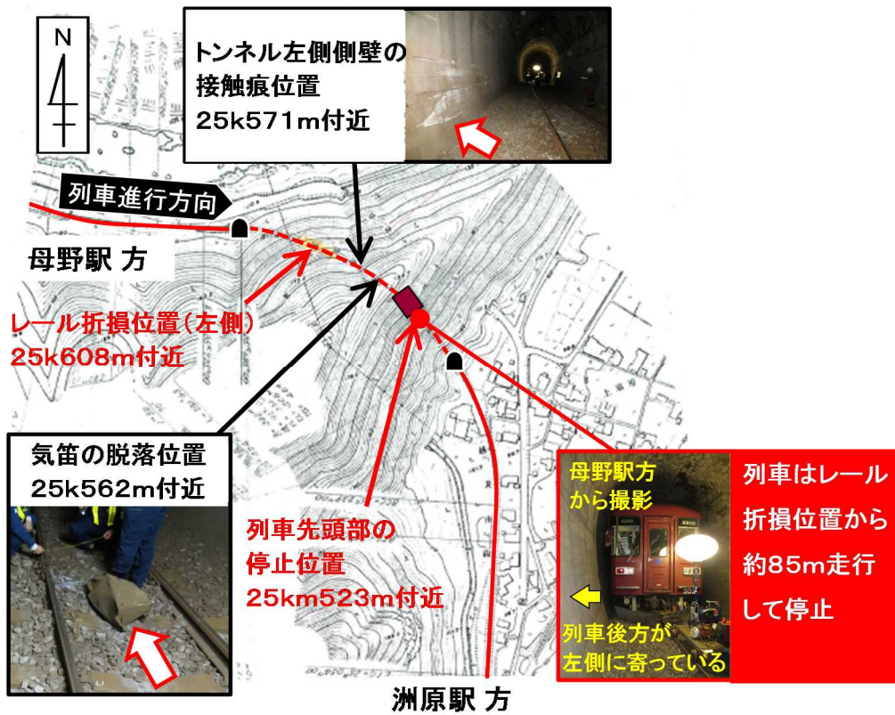
付図4 レール折損位置付近の軌道の損傷状況 (まくらぎ・締結装置の損傷箇所)
