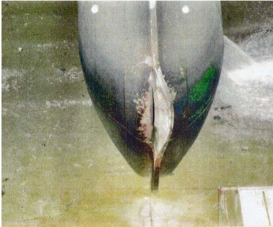
写真2 船体損傷状況
