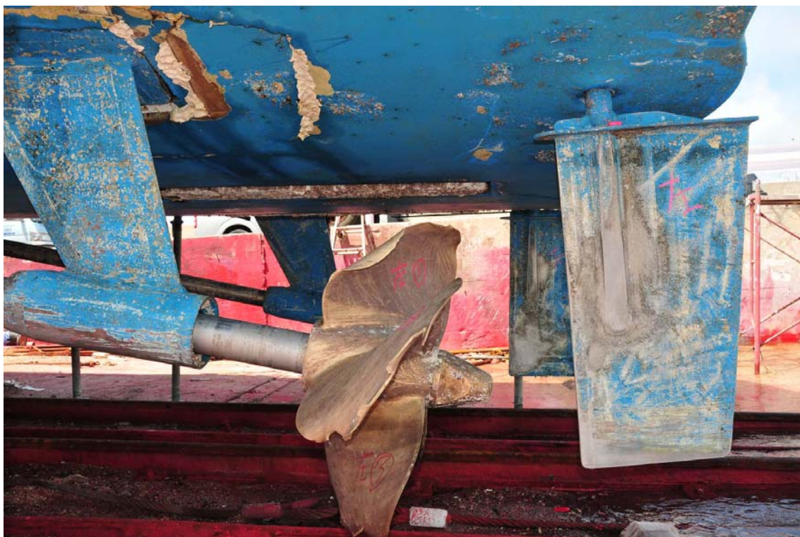
写真1 左舷船尾船底部の損傷状況
