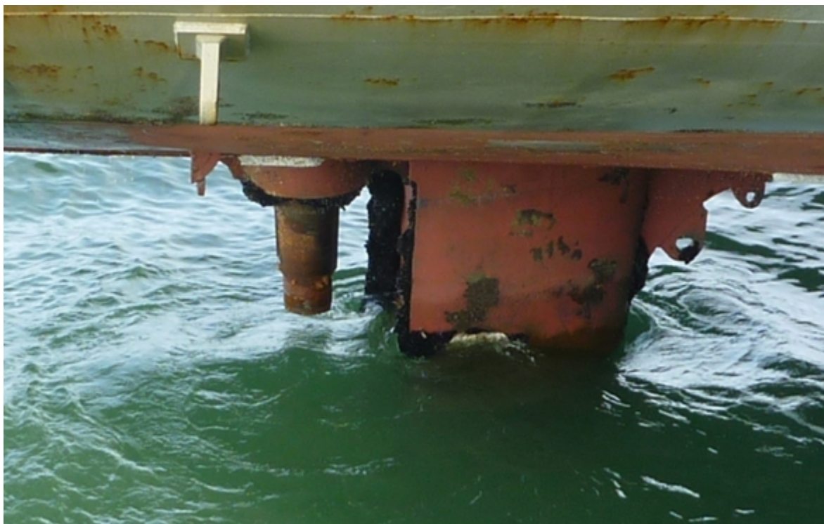
写真1 ラダーストックと外れたナット
