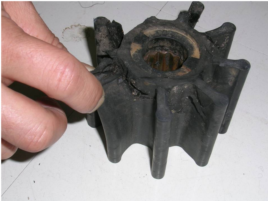
写真4 冷却海水ポンプインペラ
