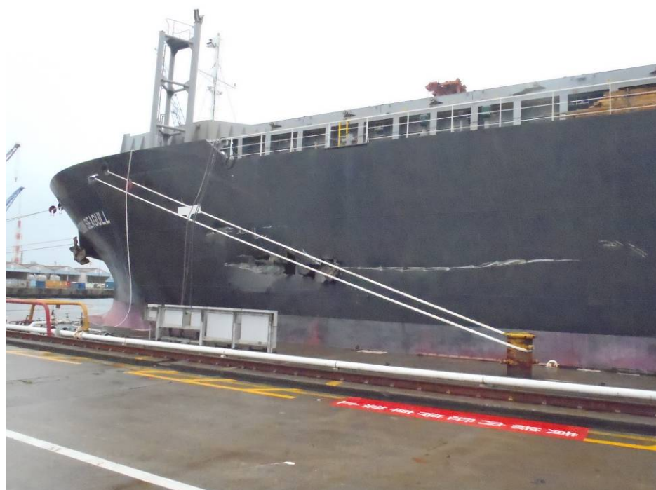
写真4 A船の損傷状況(前部その1)
