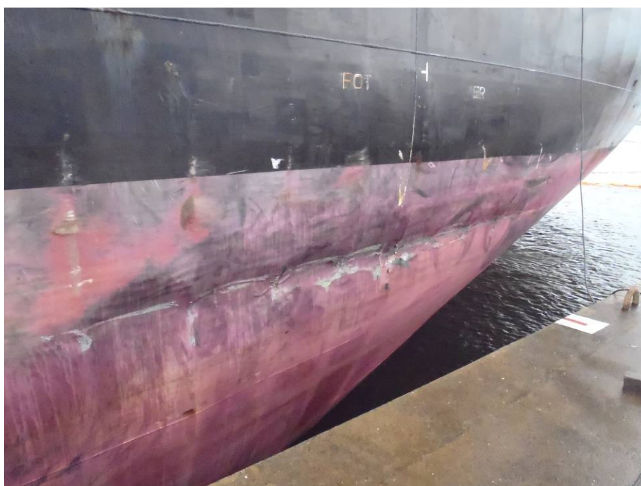
写真6 A船の損傷状況（後部その1）
