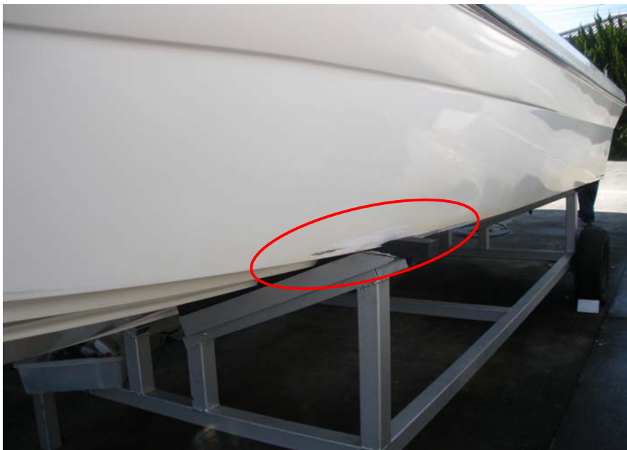
写真2 本船の損傷状況（左舷中央下部）
