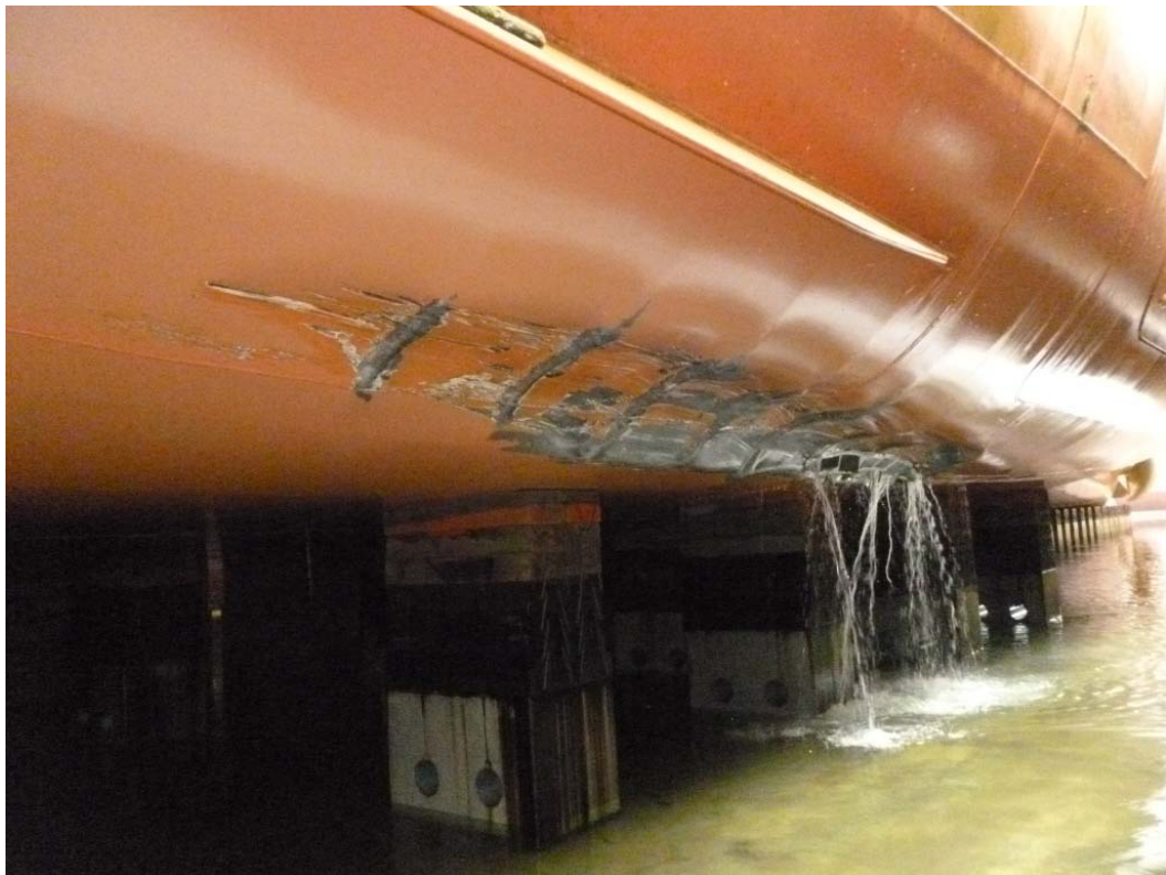
写真 4 左舷船底部の損傷状況②
