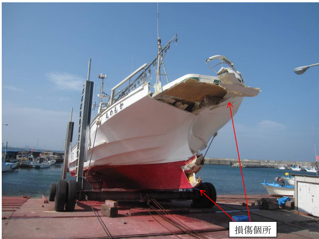
写真2 船首部及びバルバスバウ部損傷状況
