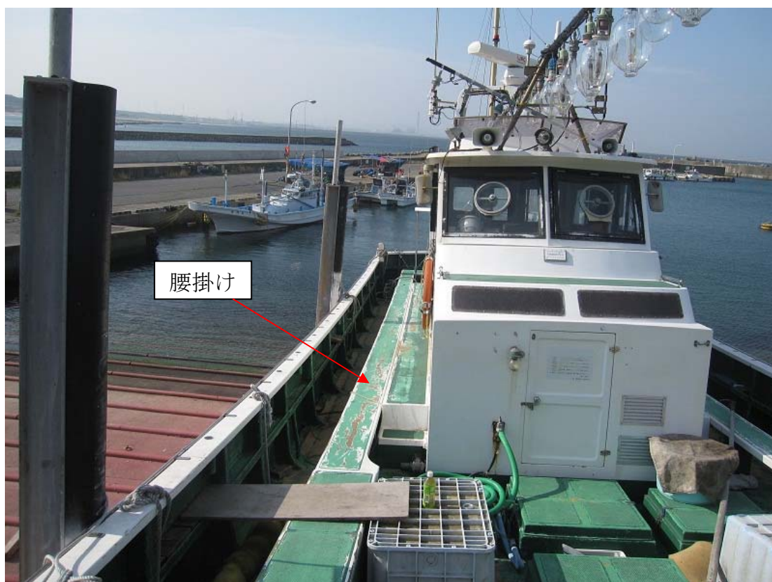
写真3 釣り客用腰掛けの設置状況
