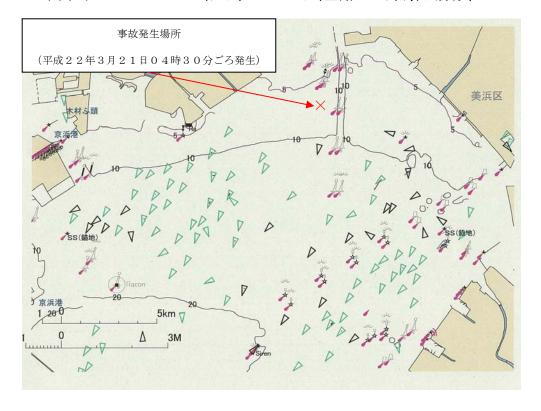
平成22年3月21日04時00分から04時30分の東京湾北部における船舶の運航状況を示している。 船体中央部に実線が記されている船舶は、30分間にAIS記録の示す船位が移動したことを意味する。
