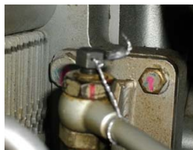
写真5.1-1 エア抜きボルトの回り止め対策
