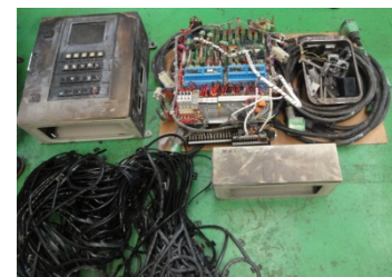
写真 2.5-12 主機制御監視装置
