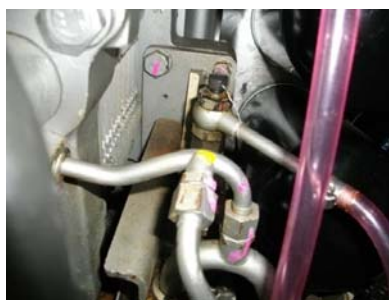
写真5.1-1 エア抜きボルトの回り止め対策
