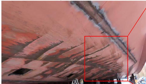
写真2 左舷中央部船底外板の損傷（凹損）
