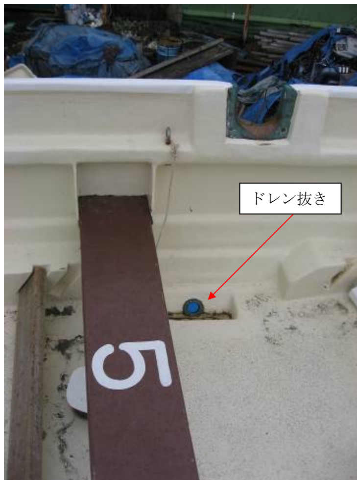
写真6 ドレン抜き（左舷側）の状況
