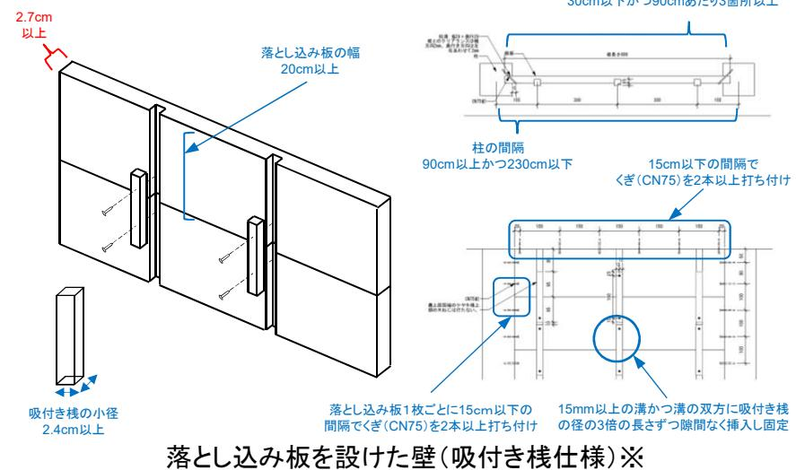
※このほか、従来と比較して、高倍率の落とし込み板を設けた壁(だぼ継ぎ)の仕様も追加
