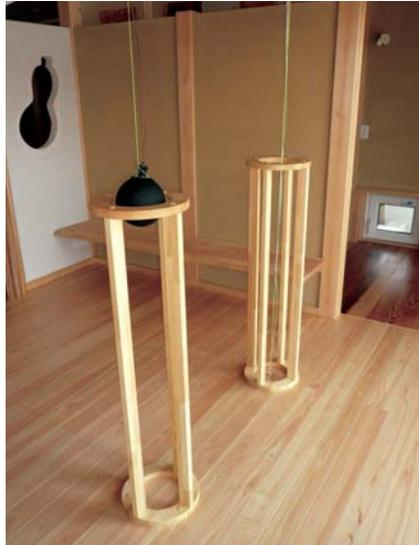
グローブ温度計を用いた室内温度計測の様子
