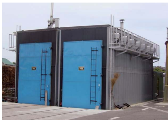
天日乾燥後、人工乾燥機により含水率を均一に揃えていく
