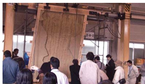
「カマゾコ」入り土壁の実証実験の様子。壁倍率2.0の結果が得られた
