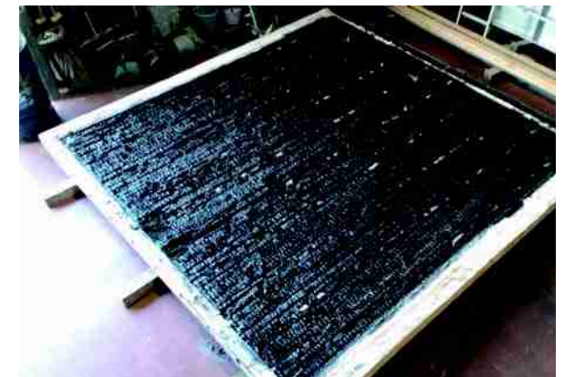
試験では60分準耐火構造の性能評価試験を実施した。
