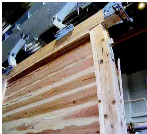
落とし込む板の凹凸をかみ合わせ、高い耐力を実現した
