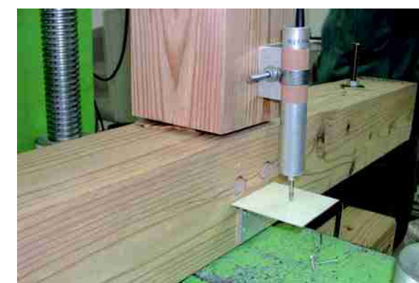
長ほぞ込栓引抜試験
