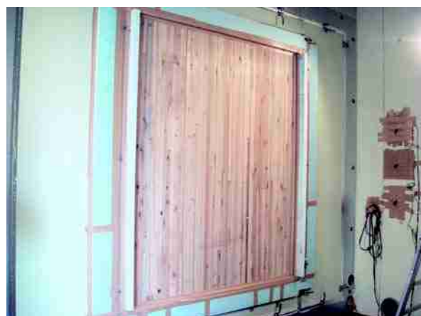
断熱性能を確認するため試験も実施した
