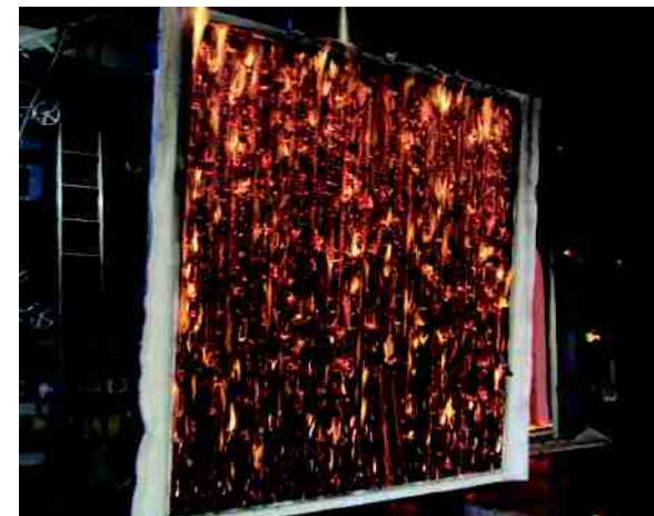
試験では60分準耐火構造の性能評価試験を実施した。
