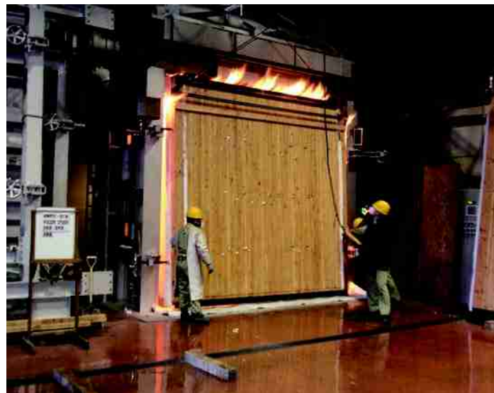
DEWS工法による構造用集成材の耐火試験の様子
