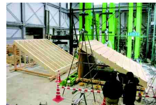
屋根パネルの水平荷重試験
