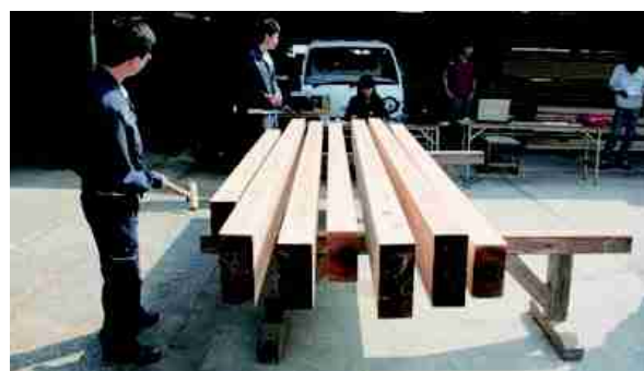
製材後のヤング係数も測定する
