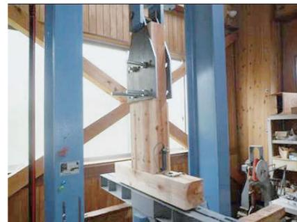
合わせ梁構造性能試験風景（引張）
