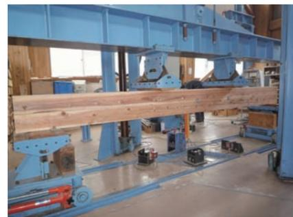
合わせ梁構造性能試験風景（曲げ）
