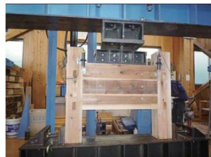
合わせ梁構造性能試験風景（せん断）
