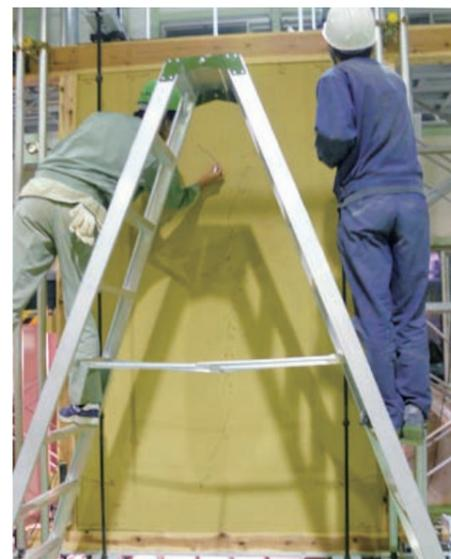
試験に利用した土壁の試験体
