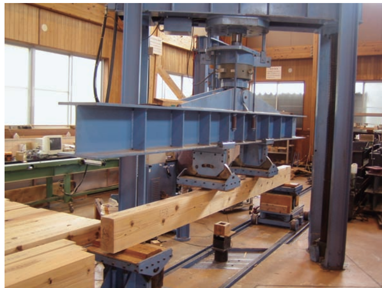
県内各地のスギ材から製材した平角材の曲げ強度試験を実施、スパン表を作成した
