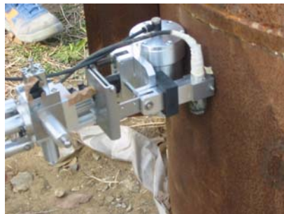
写真3 杭と試験装置の接触
