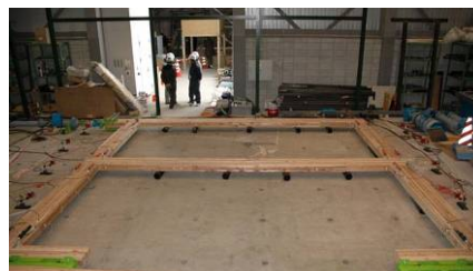
図6 2層門形架構試験状況
