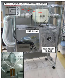
写真-1 加熱脱離装置(1号機) 図-1 加熱脱離装置(2号機)の設計図
