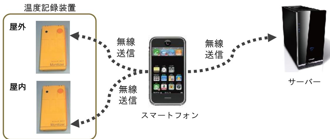
住空間(室内・屋外)に温度記録装置を置き、計測した温度情報をインターネットを用いて、サーバーにアップするシステムである。
