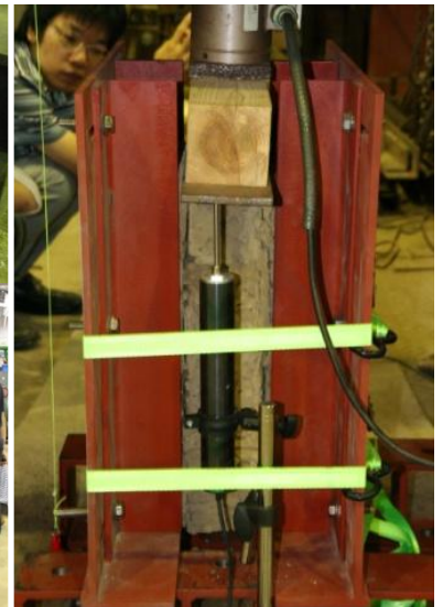
載荷装置を使用してせん断力測定
