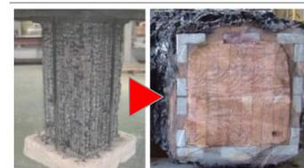
耐火性能1時間の集成材 耐火試験後の断面
