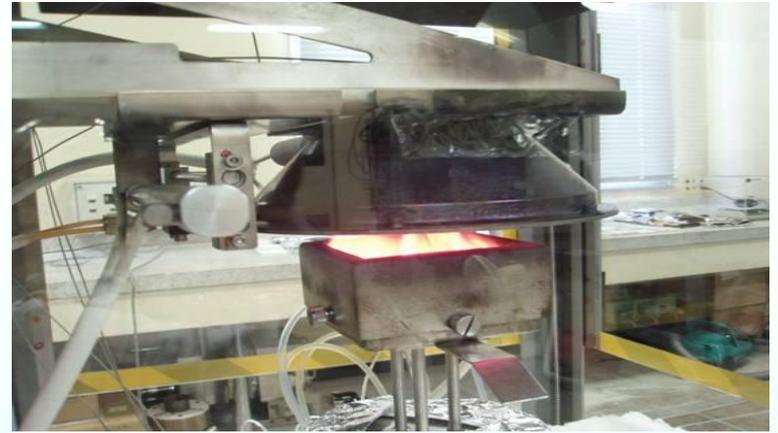
Cone Calorimeter (50kW/m<sup>2</sup>、5・10・20分)
