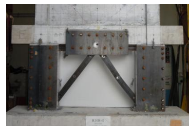
平成21年度実験結果 (破壊モード: 頂部パンチングシア)
