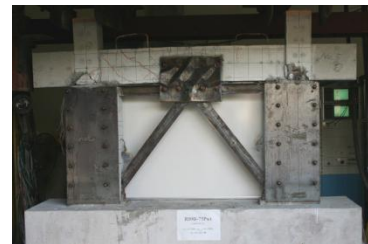
平成21年度実験結果 (破壊モード: 頂部パンチングシア)
