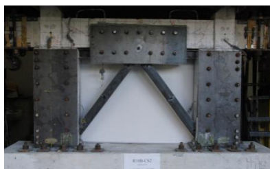
平成22年度実験結果 (破壊モード: 脚部パンチングシア)
