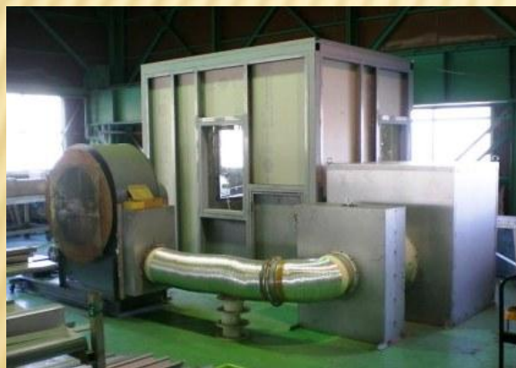
実物大給気口室実験装置
