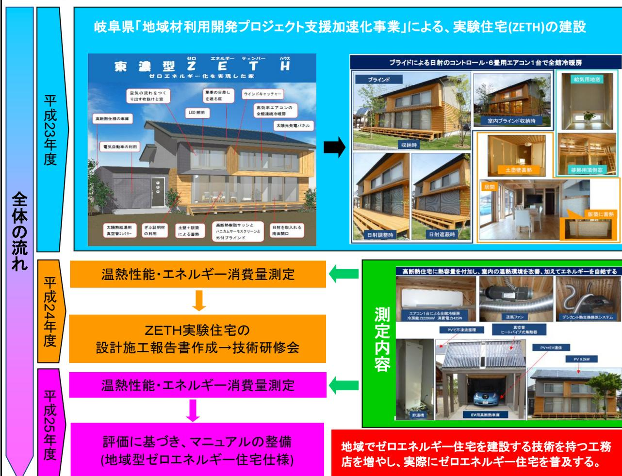
エネルギー消費量・温熱環境・換気量・気密性能他の測定と性能の評価
