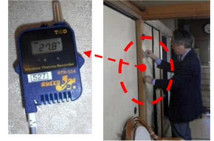
小型温湿度自動計測装置の設置
