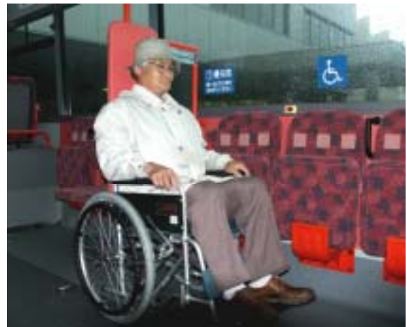
車いすを簡単かつ短時間で固定できる後ろ向き固定装置を採用しました
