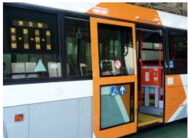
スライドアウトドアの採用により室内幅を同型車より10 cm 広げました
