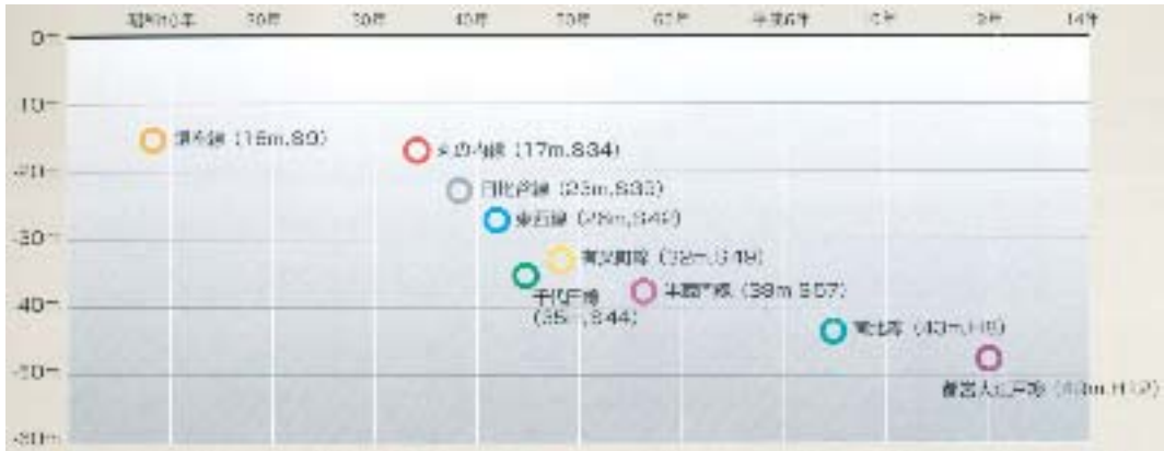
図 1-2 東京における地下鉄深度の変遷
