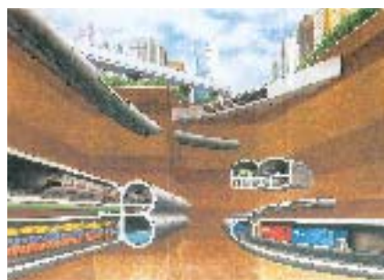
図 5-15 多様断面による地下利用
