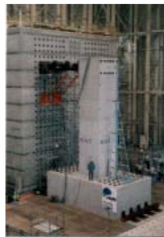
図-2 実大規模の鉄筋コンクリート柱模型を用いた性能検証実験と耐震性能の評価法の提案
