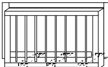
図 1 0 - 2 面格子をサッシ枠に取付ける場合の構造例
