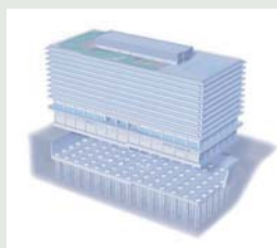
■免震レトロフィット工法 （中央合同庁舎第3号館）
