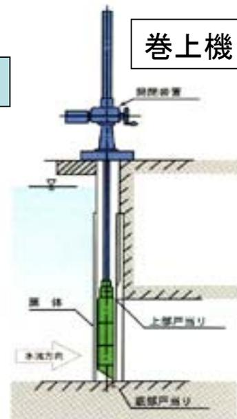
鋼製ゲートにより取水量を調整。
